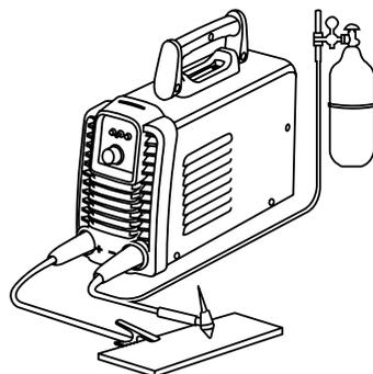
desligada e encaixe o conector do engate rápido da tocha TIG no polo – (negativo), girando-o no sentido horário para garantir sua fixação. Em seguida, engate a mangueira de gás da tocha diretamente no regulador de gás do cilindro. Verifique se todos os conectores estão bem encaixados e se não há vazamento de gás. Certifique-se de que o cilindro esteja preso em um objeto estacionário, de forma que o mesmo não possa cair e gerar uma situação de risco.
