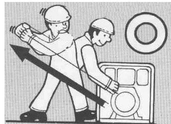
No passo 5, se a corda não for puxada com força suficiente, o motor não partirá.
