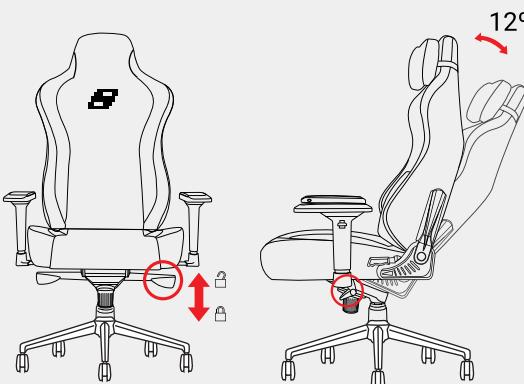
A Função Balanço (Rocking) permite inclinação em até 12º. Acione a alavanca esquerda do assento para cima e libere a função. Para deixar o mecanismo travado posicione a alavanca para baixo.
