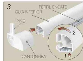
Coloque as cantoneiras nas extremidades da guia inferior. Encaixe a guia no perfil de engate e pressione. Não fixe as cantoneiras nas paredes. Observe a posição no detalhe.
