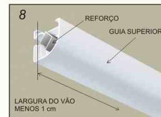
Meça a largura superior do vão e corte a guia superior com 1cm a menos. **Atenção!** o reforço em aço deve ser colocado no interior da guia.
