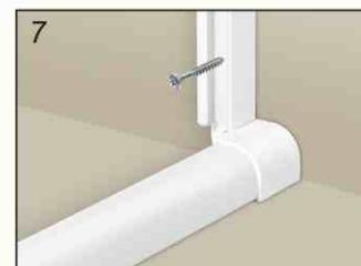
Definido o fechamento, ajuste as cantoneiras encostando nas paredes, encaixe os montantes nos pinos das cantoneiras e fixe-os com parafusos 4,2x38mm e buchas 6mm.
