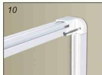
Encaixe o conjunto nos montantes e fixe nas paredes com parafusos 4,2x38mm e buchas 6mm.
