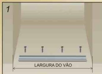
Fixe o perfil engate no piso com parafusos 4,2x32mm e buchas 6mm centralizando-o na largura do vão.
