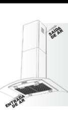
**EXAUSTOR** - O sistema de exaustão suga os vapores do cozimento filtrando e lançando para o ambiente externo através de um tubo sanfonado instalado, ligando a coifa a área externa.
