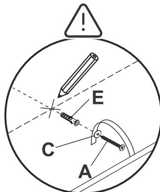
\*Faça uma marcação utilizando um lápis na posição aonde ficará o espelho, utilize a Furadeira (Broca Ø8), após faça a fixação dos componentes conforme mostra-se na imagem.
