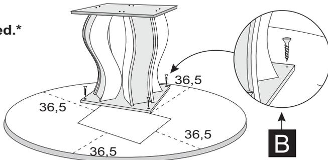
5º - CENTRALIZAR O TAMPO CONFORME MEDIDAS ABAIXO. FIXAR A BASE COM PARAFUSOS 04X25 FLANGEADO.
