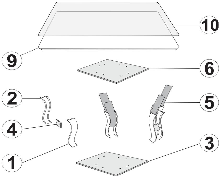
1º- INICIAR A MONTAGEM UNINDO A LATERAL Nº1 COM A LATERAL Nº2 UTILIZANDO TRAVA Nº4 E PARAFUSOS MINIFIX + TAMBOR MINIFIX. ATENÇÃO NOS PARES PARA MONTAGEM CORRETA.
