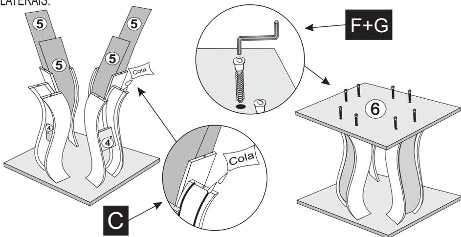
4º- CENTRALIZAR O TAMPO CONFORME MEDIDAS ABAIXO. FIXAR A BASE COM PARAFUSOS 04X25 FLANGEADO.
