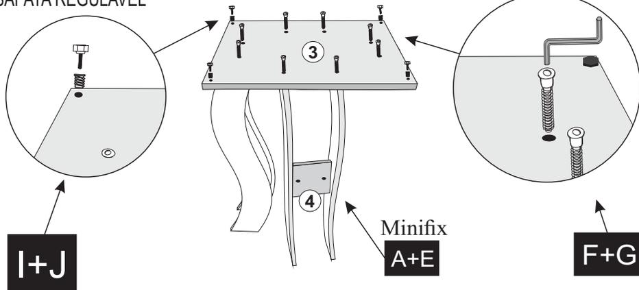
3º- CORRER OS FORROS Nº5 SOB AS LATERAIS CURVAS, UTILIZAR COLA NOS RASGOS. EM SEGUIDA, UTILIZAR PARAFUSOS 07X50 CAB. 10mm+CHAVE ZETA P/ FIXAR O SOBRETAMPO Nº6 NAS LATERAIS.
