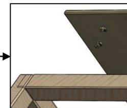
Fixar peça "F" com a "E" nas marcações do telhado, conforme o lado escolhido para montar, esquerdo ou direito.
