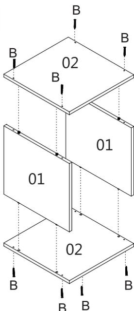
Encaixe as laterais (1) e base (2), depois coloque os parafusos.
