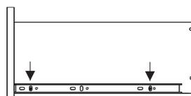
Fixação da parte móvel dos trilhos telescópico (A3331) nas gavetas com parafuso H.
