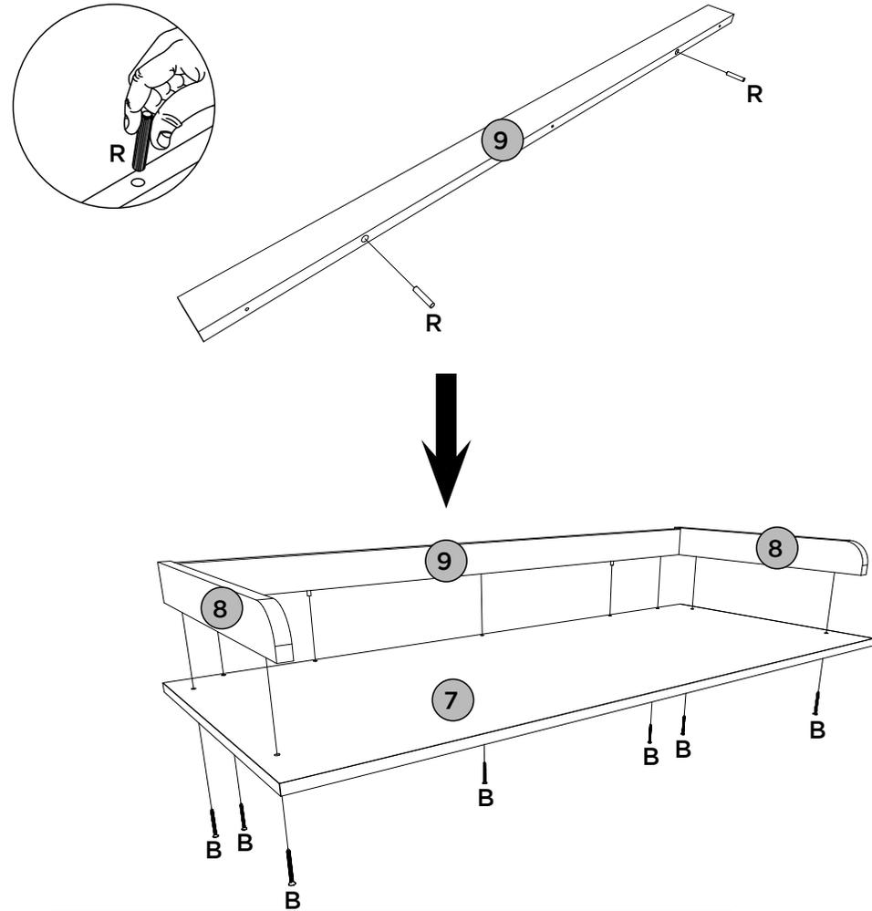
PARA COLOCAÇÃO DAS MOLDURAS NO TAMPO, É NECESSÁRIO FAZER A FURAÇÃO PASSANTE COM BROCA DE 5MM, UTILIZANDO COMO BASE AS PRÉ FURAÇÕES EXISTENTES NA PEÇA (7).
