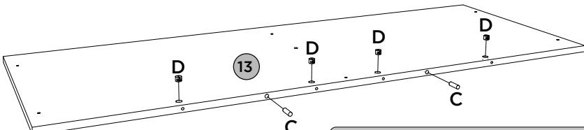
**Se o Kit (O967-64) for adquirido, é necessário inserir a porca cilíndrica (D) e a cavilha (C) no Tampa (13) antes de ser fixado ao produto.**
