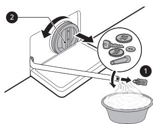
**4** Após limpar o filtro da bomba de drenagem, reinsira o filtro com cuidado e enrosque a tampa de drenagem no sentido horário com cuidado para evitar a falta de alinhamento das rosas e vazamentos. Reinsira o plugue
