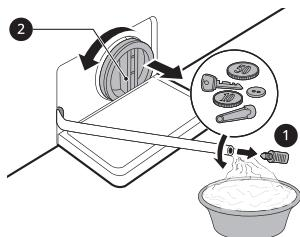
**4** Após limpar o filtro da bomba de drenagem, reinsira o filtro com cuidado e enrosque a tampa de drenagem no sentido horário com cuidado para evitar a falta de alinhamento das
