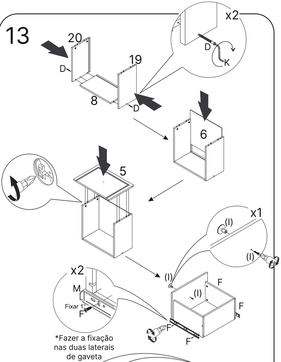
Coloque um parafuso F nos furos indicados com
