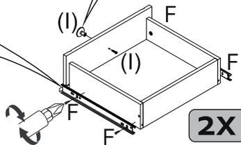
Coloque um parafuso F nos furos indicados com
