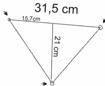
Após definir a altura e verificar que não há cabos elétricos ou encanamentos no local da parede com um lápis marque os furos conforme o triângulo na figura.
