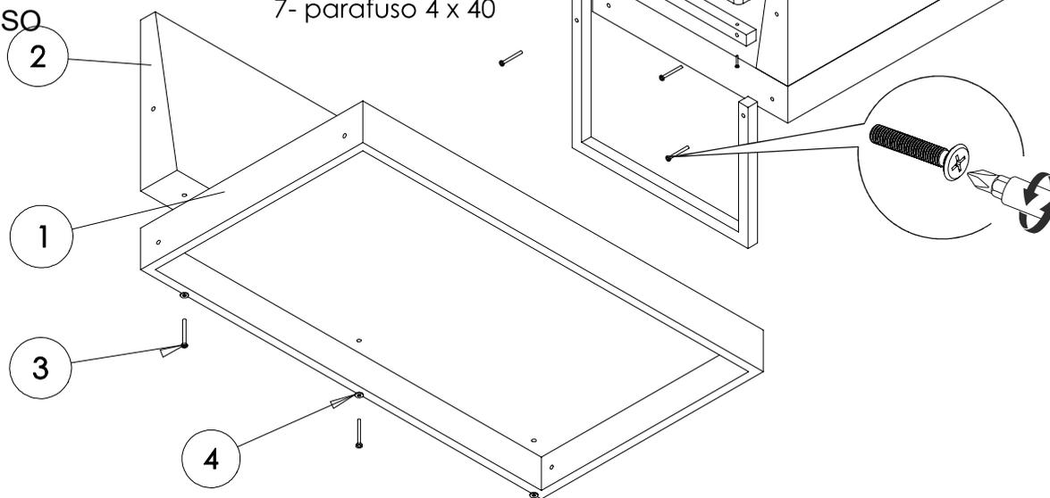
1 - Una o assento (1) com o encosto (2), utilizando parafusos (3) e arruelas (4).
