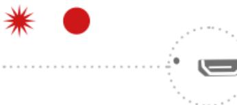
Insira o cabo de carregamento USB na entrada de carregamento e conecte a um computador ou a um adaptador e em seguida a uma fonte de energia. A luz de LED irá acender em vermelho durante o carregamento e desligar assim que a bateria estiver carregada. A luz de LED irá piscar em vermelho se o nível de bateria estiver baixo.
