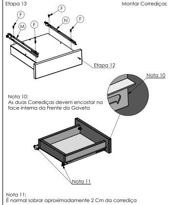
Se necessário ajuste a altura das corrediças fixas para cima ou para baixo para regular a folga e o alinhamento da gaveta. Para facilitar, folque levemente o parafuso da extremidade e reaperte novamente após obter o ajuste desejado
