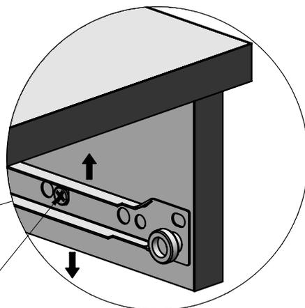
Se necessário ajuste a altura das corrediças fixas para cima ou para baixo para regular a folga e o alinhamento da gaveta. Para facilitar, folgue levemente o parafuso da extremidade e reaperte novamente após obter o ajuste desejado
