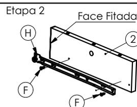
Montar Corrediça Fixa Esquerda na Lateral Esquerda da Mesa (Orientar-se pelos pré-furos)
