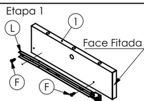
Montar Corrediça Fixa Direita na Lateral Direita da Mesa (Orientar-se pelos pré-furos)
