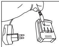
3. Conecte o carregador da bateria a uma tomada elétrica padrão.
