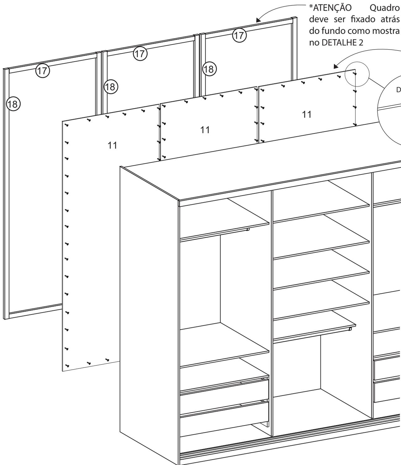
\*ATENÇÃO cada parte do fundo fica embutido no roupeiro junto com o quadro. O FUNDO deve ser parafusado por dentro do roupeiro usando parafusos flangeados
