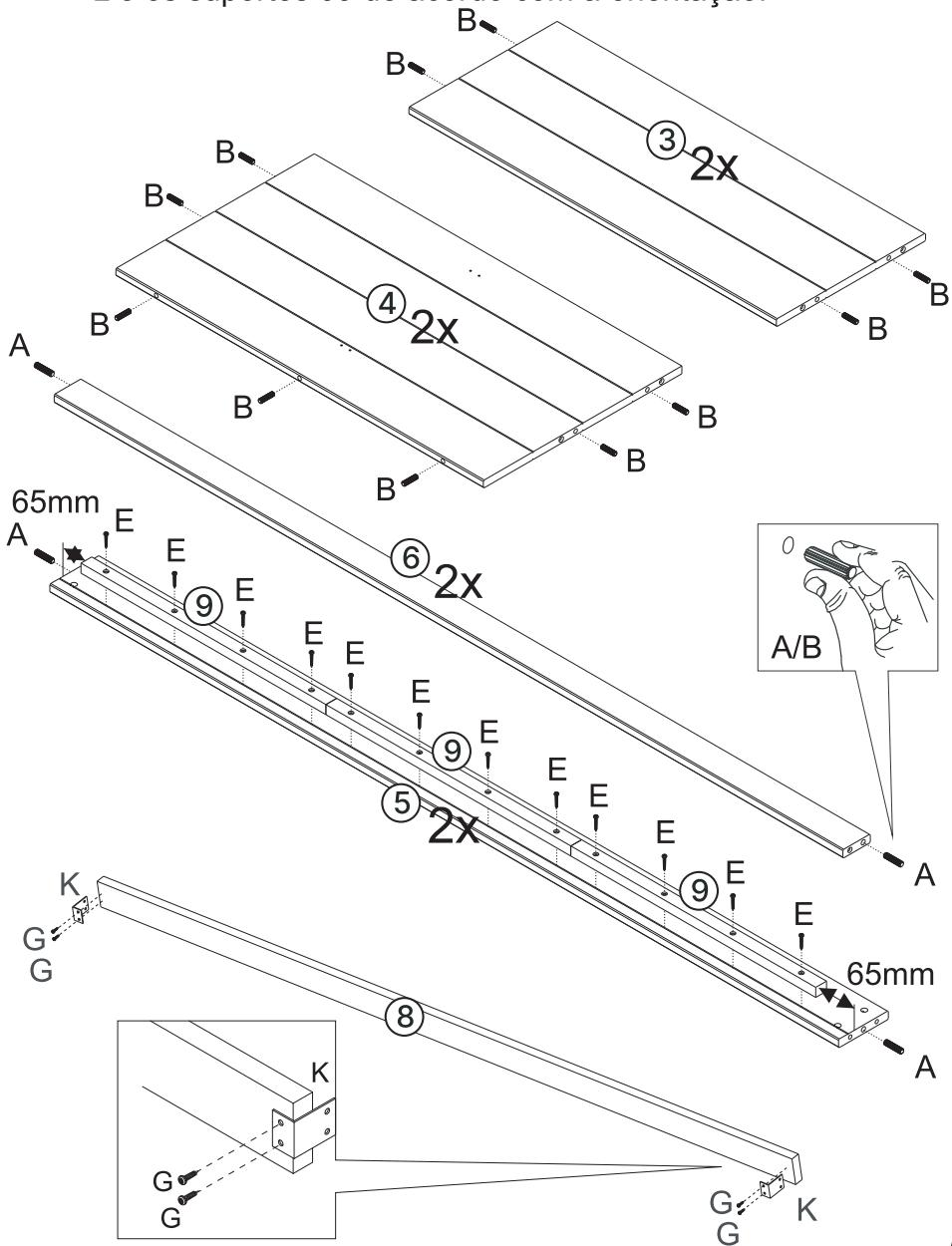
**2** Unir as peças 3 e 4 alinhando as cavilhas e posteriormente fixe as peças 1 e 2 nos painéis 3 e 4 usando parafuso C e chave F conforme detalhe.
