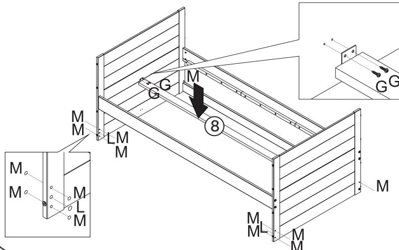
**6** Fixar os estrados (7) conforme desenho usando o distanciador (10).
