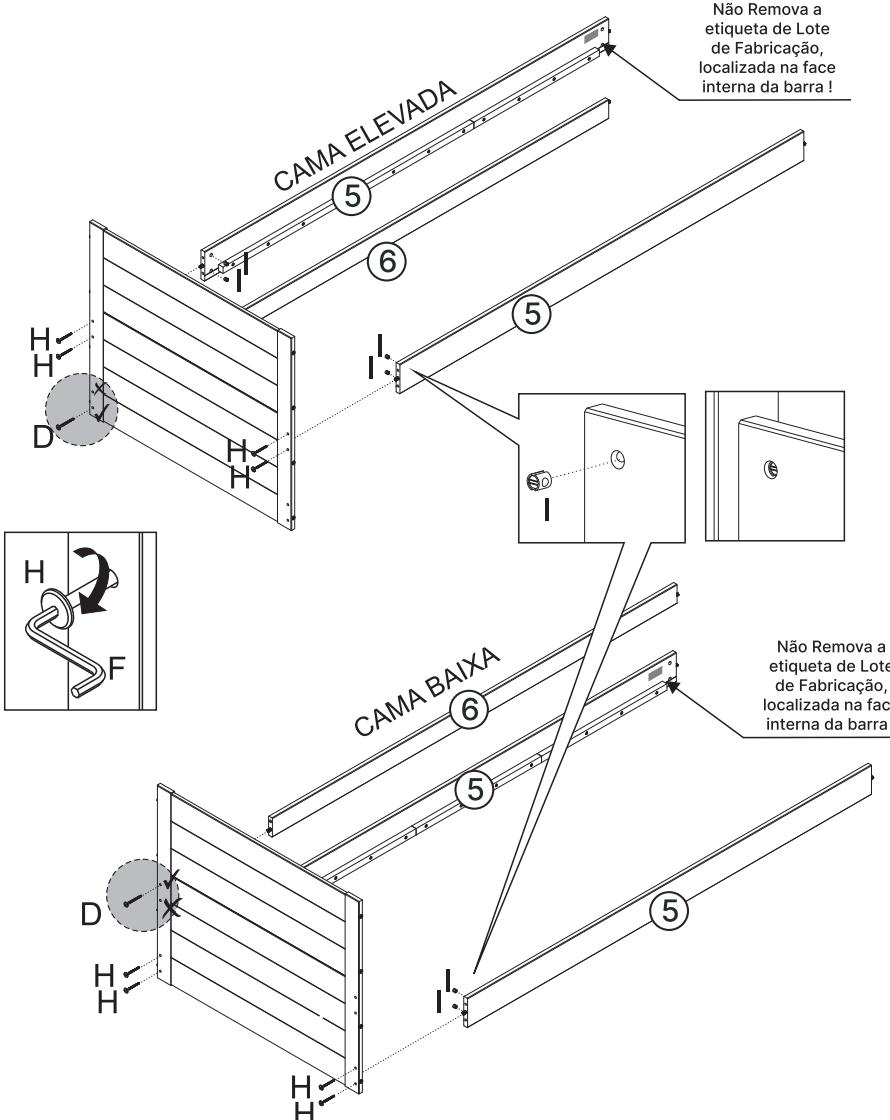
**4** Fixe o conjunto montado usando parafuso H, chave F e porca I conforme detalhe.
