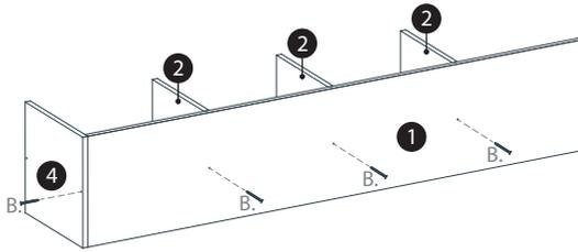
02. Insira cavilhas (A) nas peças "2" e "4", montadas no passo anterior. Após, faça o encaixe da peça "1" restante e parafuse com parafusos 3,5x40mm (B).
