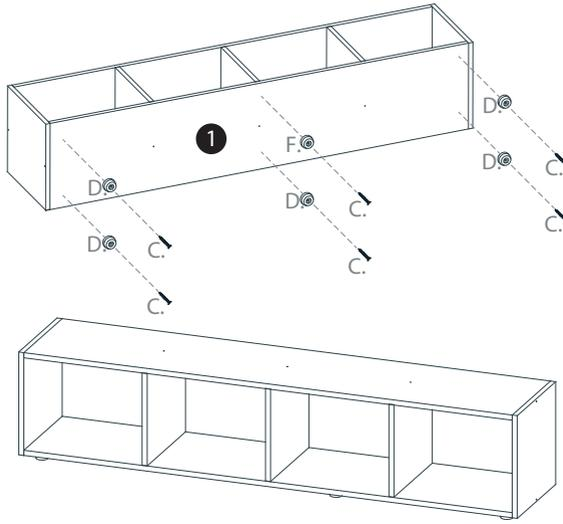
Para o uso vertical, são necessárias 4 sapatas para apoiar o móvel. Para montá-las, posicione-as sobre a peça "4" e parafuse-as com parafusos 3,5x25mm (C).
