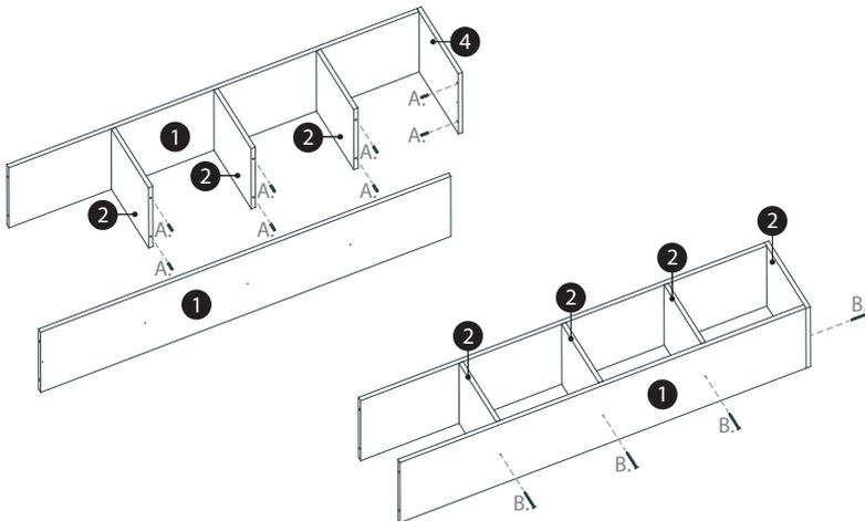
03. Insira cavilhas (A) nas peças "1" montadas nos passos anteriores. Após, encaixe a peça "4" restante e parafuse com parafusos 3,5x40mm (B).
