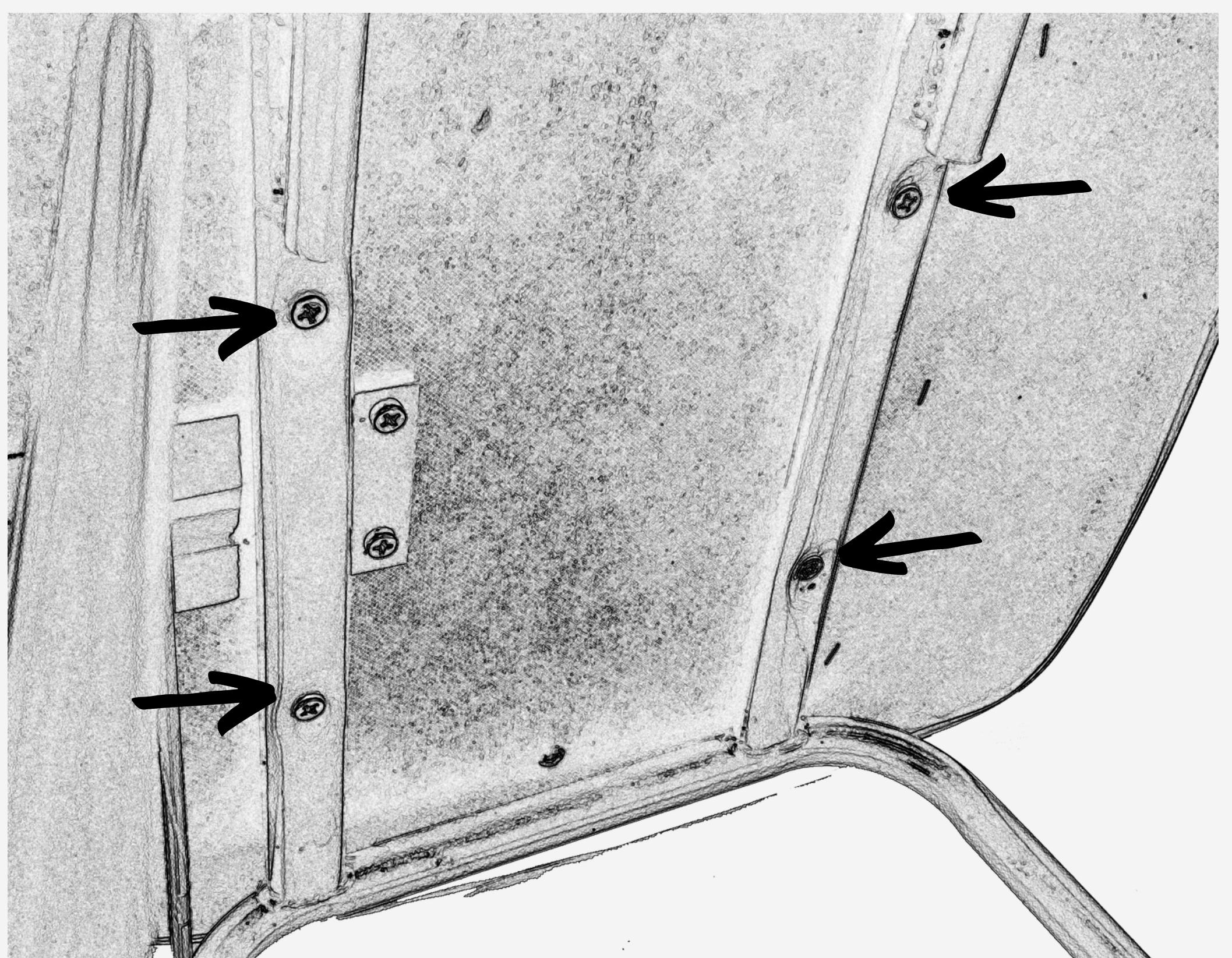
Para adicionar o braço corsa, é só parafusar nos pontos indicados.
