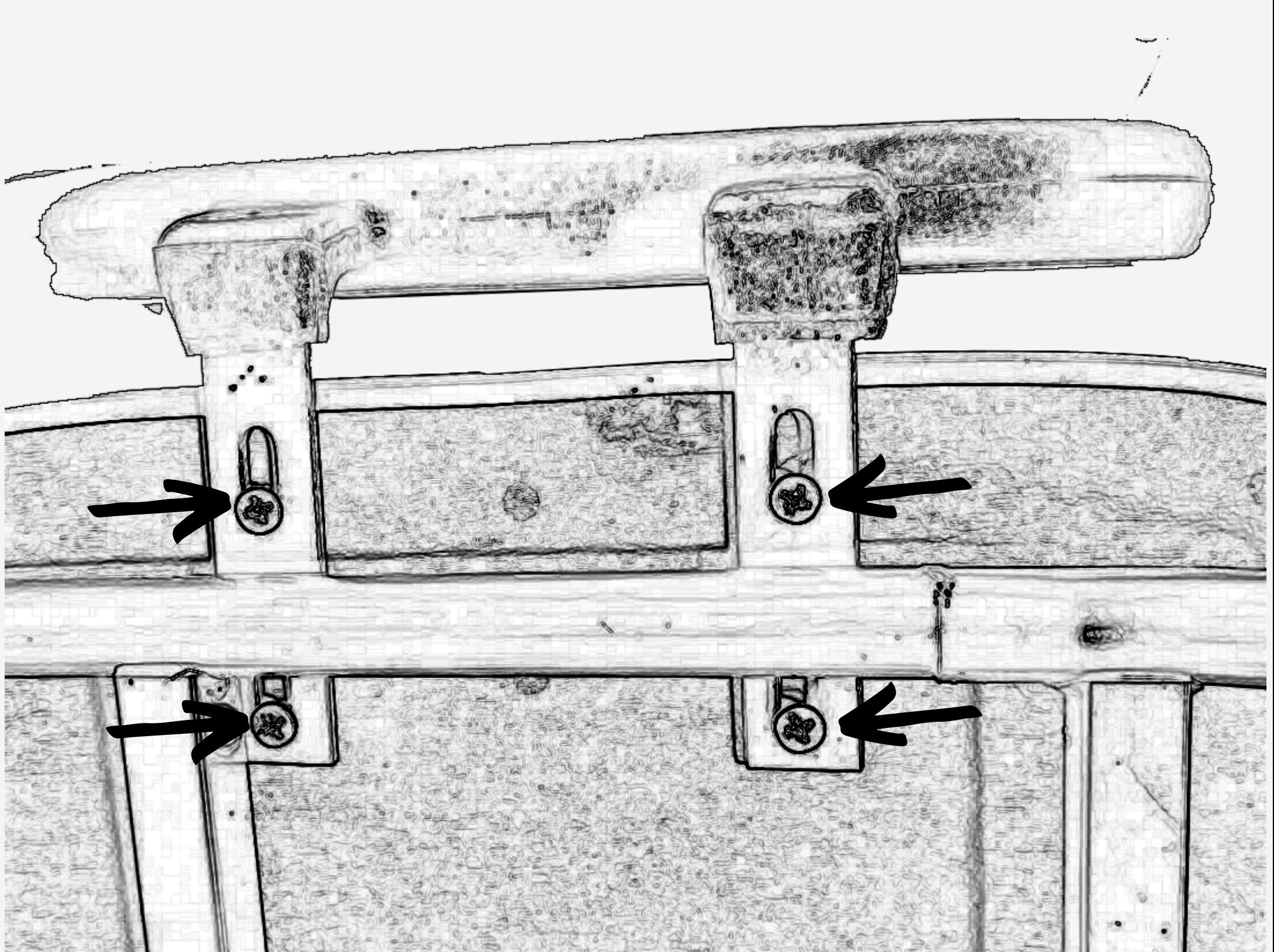
A lâmina central vem acoplada no encosto, você irá parafusá-la no assento.
