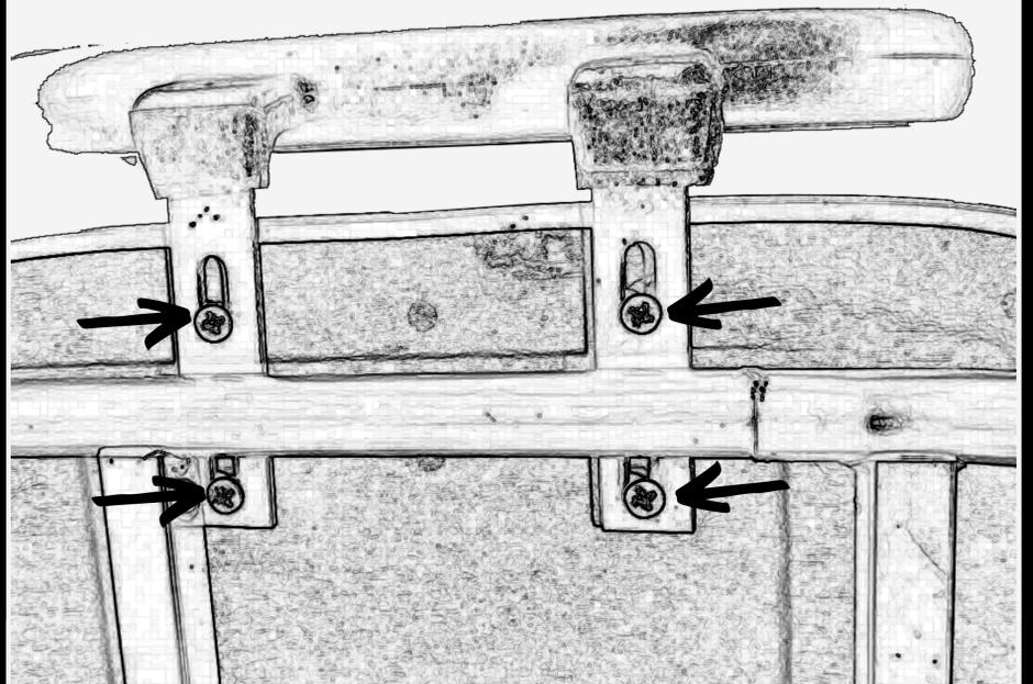
A lamina central vem acoplada no encosto, você irá parafusar no assento.
