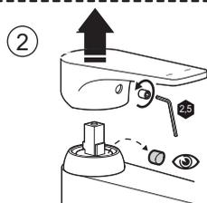
Para remoção do volante, utilizar chave allen de 2,5 mm.
