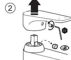
Para remoção do volante, utilizar chave allen de 2,5 mm.
