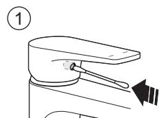
Empurrar a borracha de proteção (vedação) para dar acesso a chave allen para soltar o parafuso.
