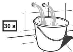
Antes de instalar o produto, abra o registro e deixe correr água para remover todos os resíduos da tubulação. Utilize fita teflon nas conexões, se necessário.
