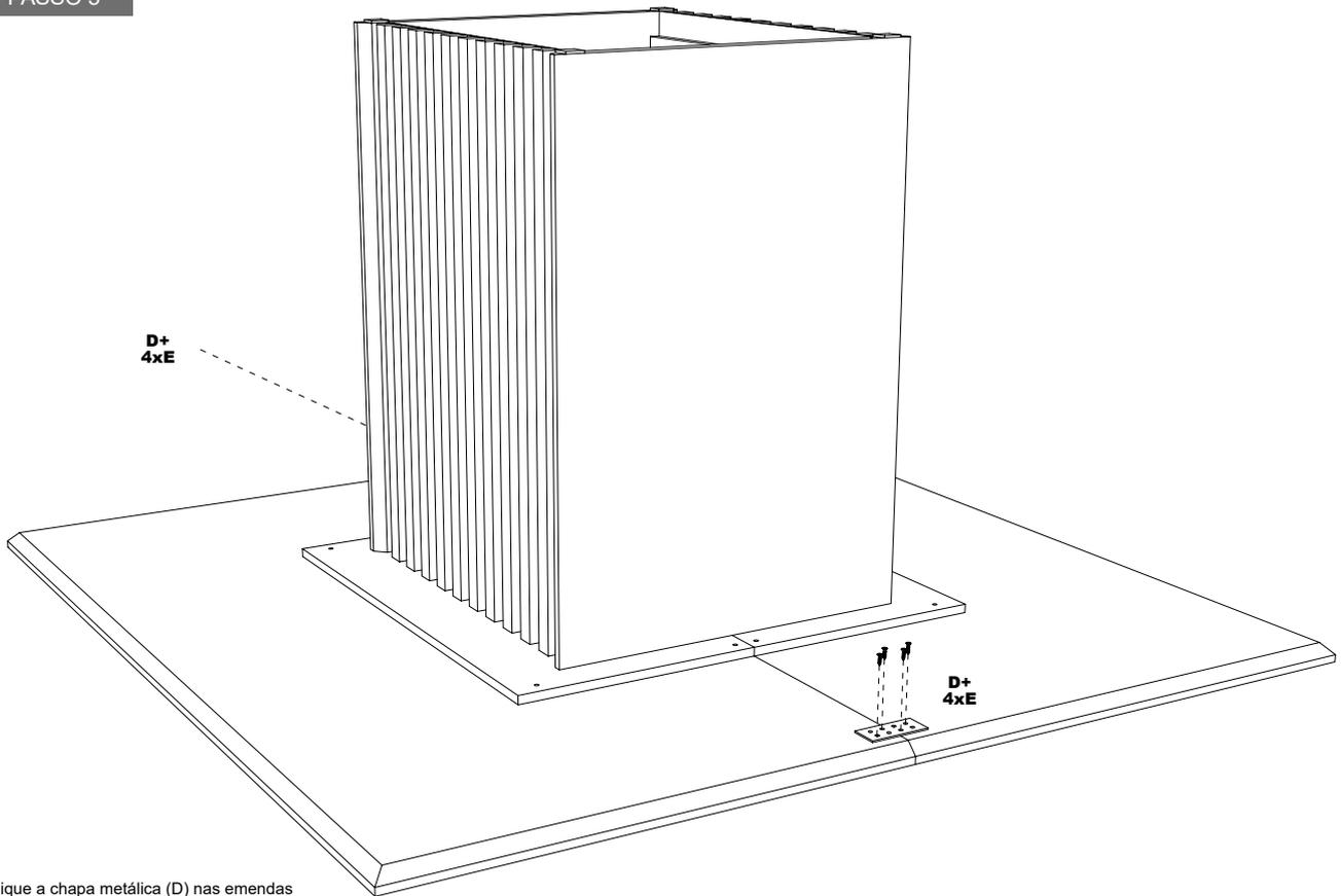
Aplique a chapa metálica (D) nas emendas do tampo (4) utilizando os parafusos 3,5x14 (E).
