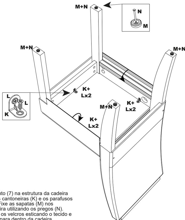
Fixe o assento (7) na estrutura da cadeira utilizando as cantoneiras (K) e os parafusos 3,5x14 (L). Fixe as sapatas (M) nos pés da cadeira utilizando os pregos (N). Depois, una os velcros esticando o tecido e dobrando-o para dentro da cadeira.
