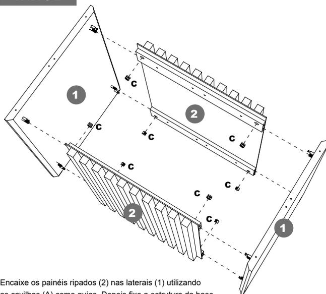
Encaixe os painéis ripados (2) nas laterais (1) utilizando as cavilhas (A) como guias. Depois fixe a estrutura da base utilizando os tambores mini-fix (C).
