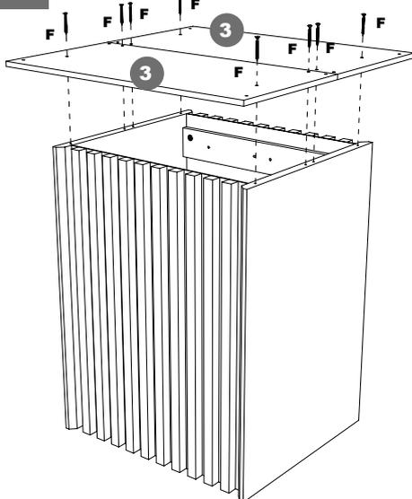
Fixe os 2 apoios do tampo (3) no topo da estrutura da base, montada anteriormente, utilizando os parafusos 5x50 (F).
