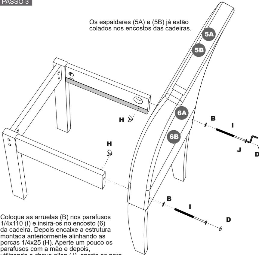
Coloque as arruelas (B) nos parafusos 1/4x110 (I) e insira-os no encosto (6) da cadeira. Depois encaixe a estrutura montada anteriormente alinhando as porcas 1/4x25 (H). Aperte um pouco os parafusos com a mão e depois, utilizando a chave allen (J), aperte os parafusos até que fiquem bem firmes. Depois, cubra-os utilizando as tampas (D).
