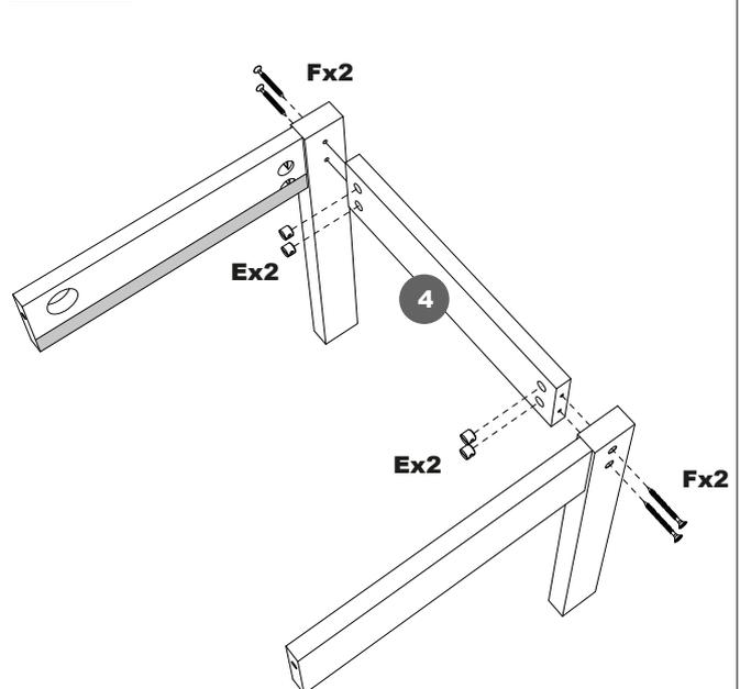
Utilize as porcas cilíndricas (E) com os parafusos 5x50 (F) para fixar os conjuntos montados anteriormente na travessa inferior (4).
