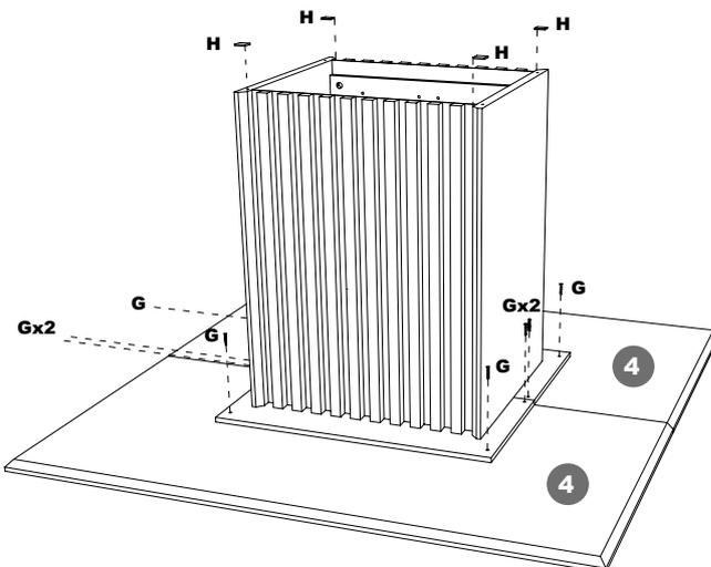
Alinhe os dois tampos da mesa (4) conforme indica a ilustração. Fixe a base nos tampos utilizando os parafusos 4,5x30 (G). Depois, cole as sapatas de borracha adesiva (H) nos pés das laterais (1).
