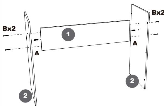
Junte a travessa (1) e as laterials maiores da travessa (2) e fixe-as utilizando os parafusos 5x40 (B).
