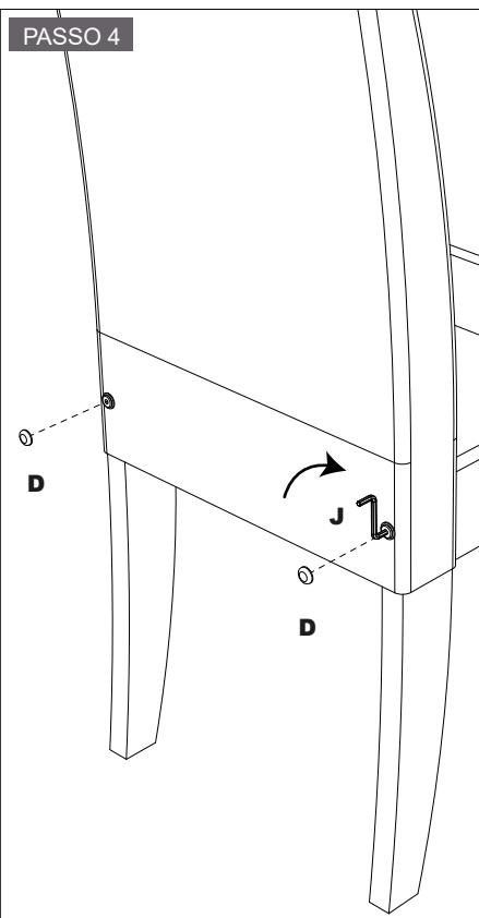
Utilizando a chave allen (J), aperte os parafusos até que fiquem bem firmes. Depois, cubra-os utilizando as tampas (D).
