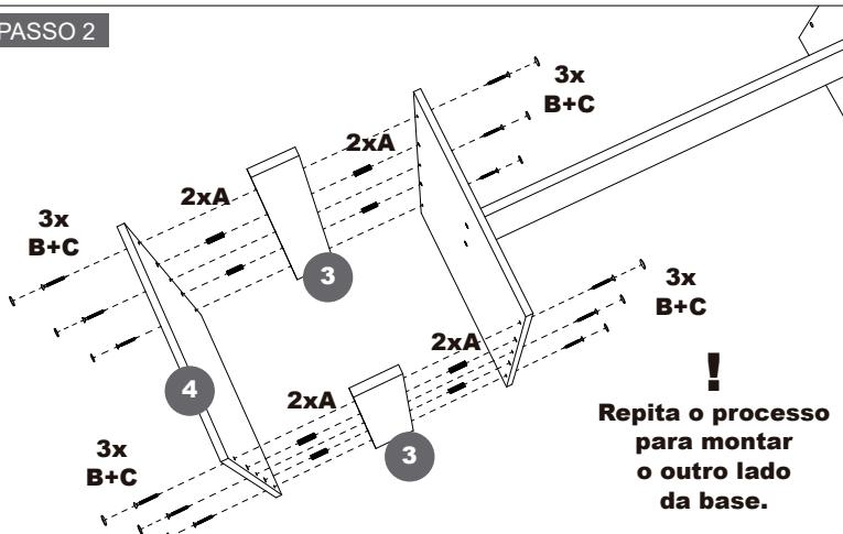
Junte a lateral maior (4) às laterais menores (3) e à lateral maior da travessa (2) utilizando as caviglias (A) como auxílio. Fixe tudo utilizando os parafusos 5x50 (B) e tampe-s os tapa-furos (C).
