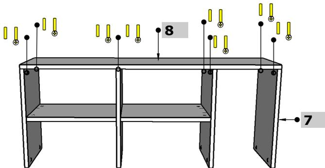
**4º Passo:** Instalar a peça (1,3,5 e 7) sobre a peça(6).
