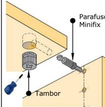
O minifix é um sistema de montagem para união de chapas ou compensados. Seu funcionamento é simples:
