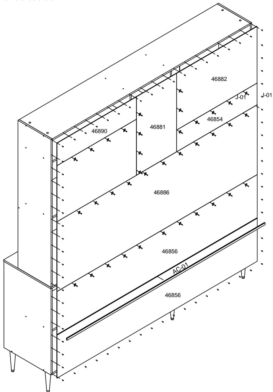
**Passo 1:** Utilizar parafusos B-02 para fixar os trilhos na lateral e usar cavilhas A-01 e minifix B-01 para unir as laterais na frente gaveta.
