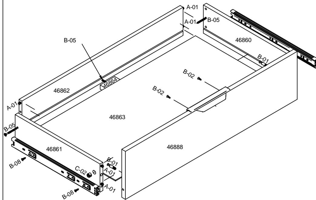
**Passo 2:** Utilizar parafusos B-02 para fixar os trilhos na lateral e na divisão.
