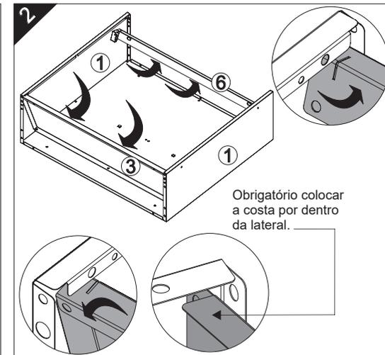
Obrigatório colocar a costa por dentro da lateral.
