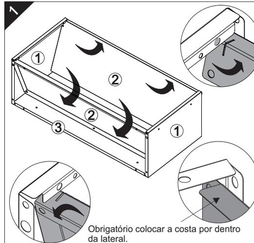
Obrigatório colocar a costa por dentro da lateral.
