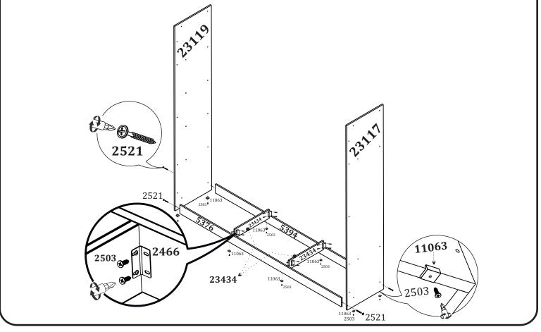
Fixe a base (23120) nas laterais (23117/23119) com os parafusos (2521) e em seguida, fixe nos rodapés (5376/5394) utilizando os parafusos (2505).
