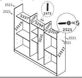
**6** Encaixe o tampo (23121) nas cavilhas (2473) das divisões (23504/23505). Em seguida, com os parafusos (2521) fixe o tampo nas laterais (23117/23119).
