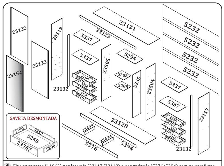
Fixe as sapatas (11063) nas laterais (23117/23119) e nos rodapés (5376/5394) com os parafusos (2503). Fixe as laterais (23117/23119) nos rodapés (5376/5394) utilizando os parafusos (2521) e em seguida, fixe as travessas (23434) entre os rodapés utilizando as cantoneiras (2466) e os parafusos (2503).
