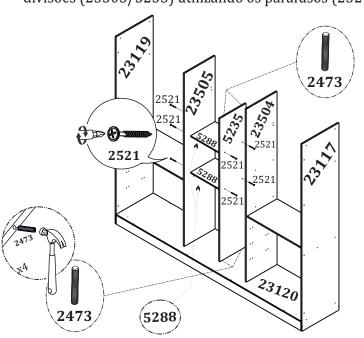
Fixe as prateleiras (5337) entre as laterais e as divisões (23504/23505) utilizando os parafusos (2521). Encaixe a prateleira (5294) sobre as cavilhas fixadas na divisão (5235) e fixe nas divisões (23504/23505) com os parafusos (2521).
