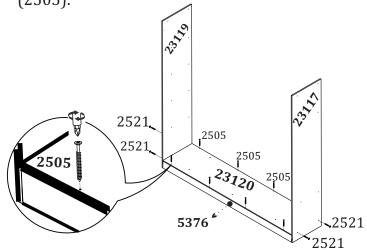
Fixe as cavilhas (2473) nas divisões (23504/23505) e encaixe na base (23120). Em seguida, fixe as prateleiras (5337) entre as laterais (23117/23119) e as divisões (23504/23505) utilizando os parafusos (2521).
