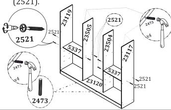
Fixe a divisão (5235) na base (23120) utilizando as cavilhas (2473). Fixe as prateleiras (5288) entre as divisões (23505/5235) utilizando os parafusos (2521).
