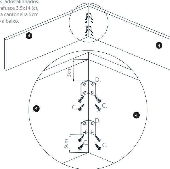
04. Encaixe o telhado montado na montagem da estrutura da estante. Fixe duas dobradiças (d) em cada lateral utilizando os parafusos 3,5x14 (c). Deixando cada cantoneira 5cm de cada lateral. Conforme ilustração a baixo.
