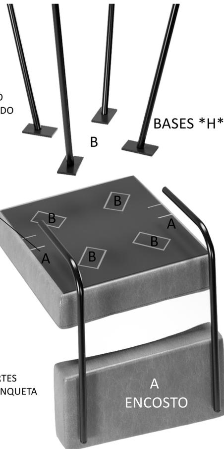
**B** - PARAFUSAR AS 02 BASES \*H\* NA MARCAÇÃO DO GABARITO COMO NA FIGURA AO LADO COM, OS PARAFUSOS 4,2X19.
