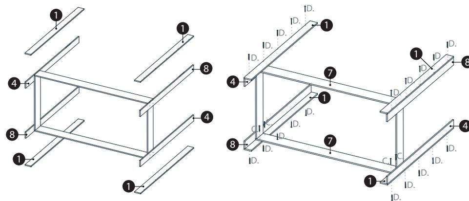
4. Faça a montagem de 08 sapatas 15x15mm (I) nas peças "1", "4" e "8" da estrutura, com 08 pregos 10x10mm (G).
