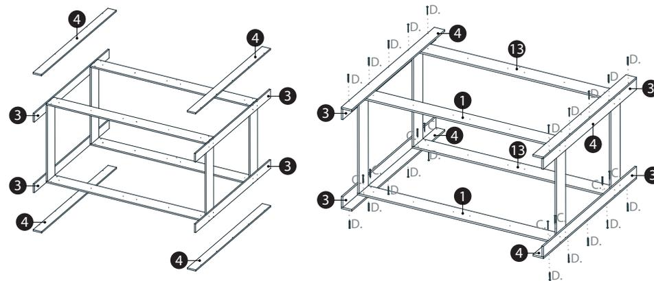
4. Faça a montagem de 08 sapatas 15x15mm (I) nas peças "4" e "3" da estrutura, com 08 pregos 10x10mm (G).
