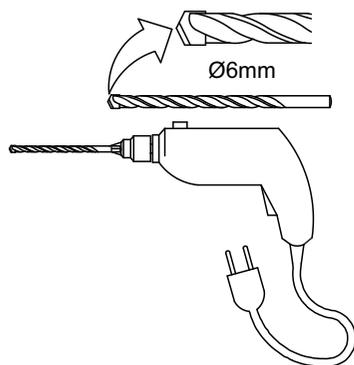
5º - Com uma Furadeira e uma Broca 6mm de diâmetro (Não Inclusos), faça a furação para encaixar a Bucha plástica de 6mm de diâmetro
