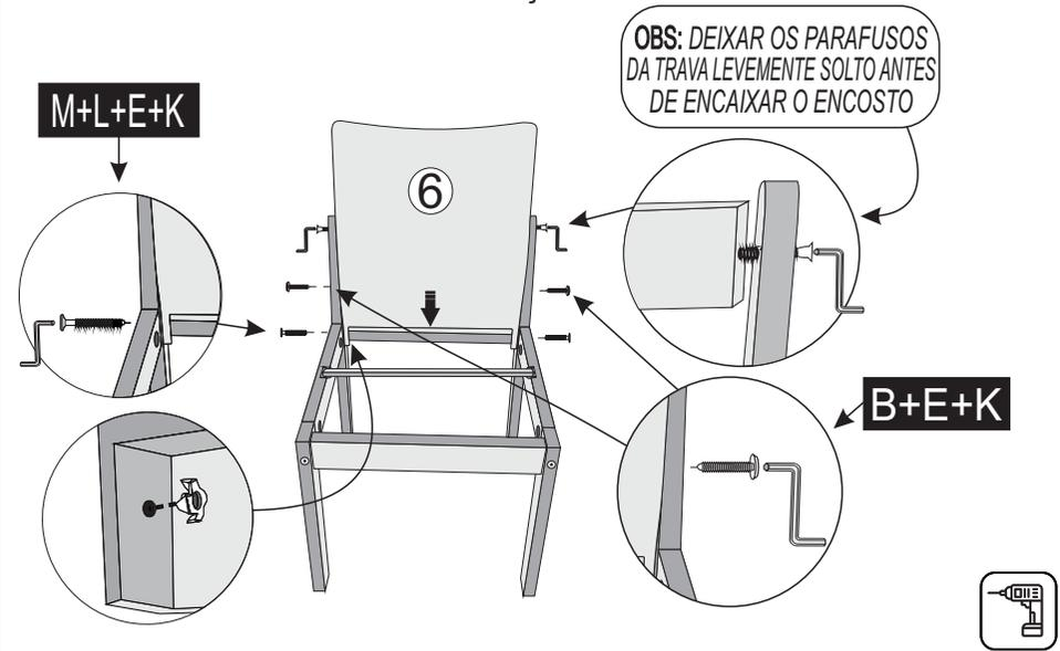
4º FINALIZAR JUNTANDO ASSENTO Nº8 AO ENCOSTO Nº6, PARAFUSANDO AS CHAPAS JUNÇÃO 04 FUROS+PARAFUSOS 3,5X12. EM SEGUIDA, FIXE AS CANTONEIRAS 2 E 4 FUROS NO ASSENTO Nº5 E TRAVAS COM PARAF. 3,5X12. **OBS: JUNTAR BEM ENCOSTO E ASSENTO PARA NÃO DAR ESPAÇO ENTRE OS MESMOS.**
