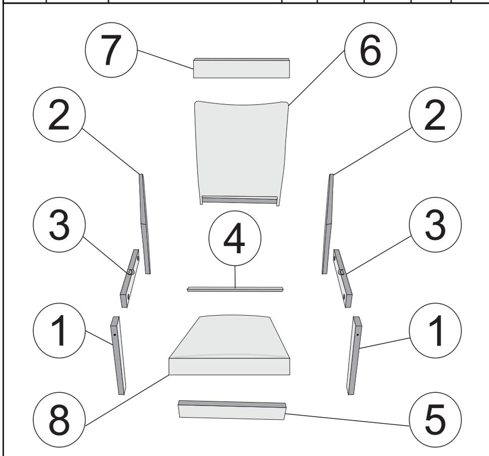
1º - MONTAR O PÉ Nº1 E O PÉ Nº2 COM A TRAVA Nº3.FAZER LADO DIREITO E ESQUERDO. UTILIZANDO ANEL FIXADOR+PARAFUSOS 1/4X100 CAB 17mm. COLOCAR SAPATA DESLIZADORA NO CONJUNTO+TAMPA FURO 17mm. REPITA O PROCESSO NAS OUTRAS PEÇAS.
