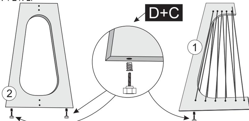
2º - EM SEGUIDA, UNIR PEÇA Nº1 NA PEÇA Nº2, UTILIZANDO PARAF. 07X50 CAB.10 +CHAVE ALEN E TRAVAR TUDO COM CHAPA SUPORTE "T" + PARAF. 3,5X20.
