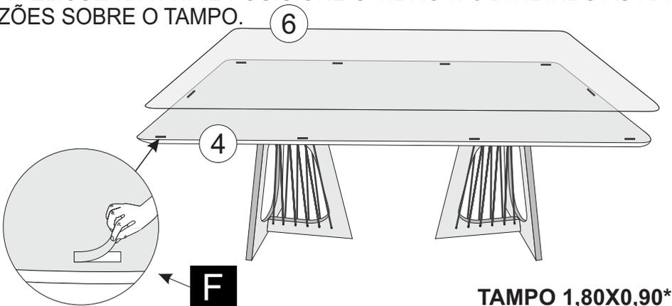
5° - PARA FINALIZAR A MONTAGEM, RETIRE A FITA DUPLA FACE DA CARTELA E COLE SOBRE O TAMPO Nº5, EM SEGUIDA, RETIRE A PELÍCULA DA FITA E POSICIONE O VIDRO Nº7 DIVIDINDO AS RAZÕES SOBRE O TAMPO.
