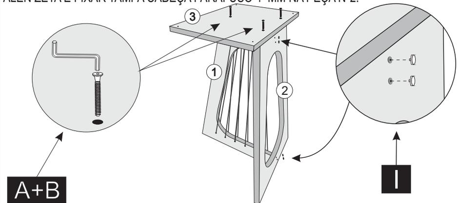
4° - FINALIZE A MONTAGEM CENTRALIZANDO A BASE SOBRE O TAMPO Nº4 UTILIZANDO AS MEDIDAS ABAIXO E FIXE COM PARAF. 04X25 FLANG.
