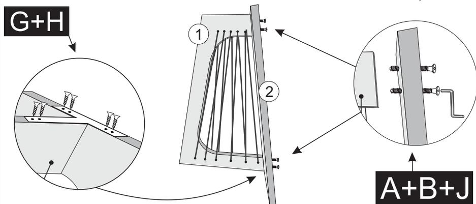
3º - FIXE PEÇA Nº3 NAS PEÇAS Nº1 E Nº2, UTILIZANDO PARAF. 07X50 CAB. 10mm+CHAVE ALEN ZETA E FIXAR TAMPA CABEÇA PARAFUSO 4 MM NA PEÇA Nº2.
