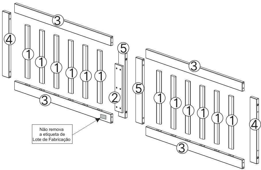
**1** Encaixe as peças (1) nas peças (3) conforme desenho.
