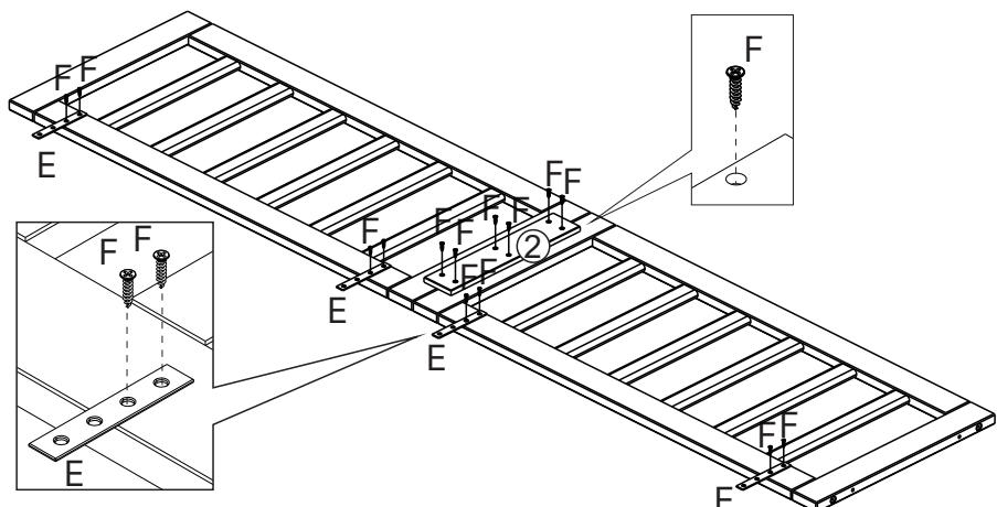
**5** Fixe as grades usando os parafusos (D e E) e chave (A) conforme detalhe.
