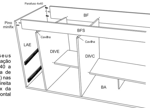
Encaixe as cavilhas em seus respectivos furos e finalize a fixação parafusando com parafusos 4x40 a lateral esquerda (LAE) na barra de fundo (BF) e a barra de fundo (BF) nas divisórias esquerda (DIVE) e direita (DIVD). Encaixe o Pino minifix da lateral esquerda (LAE) na barra frontal superior (BFS).
