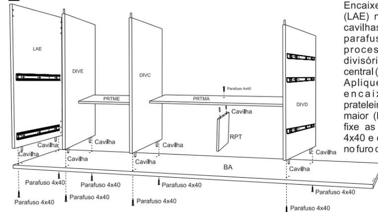
Encaixe a lateral esquerda (LAE) na base (BA) com as cavilhas. Fixe utilizando os parafusos 4x40. Repita o processo para montar a divisória esquerda (DIVE), central (DIVC) e direita (DIVD). Aplique as cavilhas para encaixar o reforço da prateleira (TRV) na prateleira maior (PRTMA). Em seguida fixe as peças com parafuso 4x40 e cole o tapafuro branco no furo do reforço da divisória.
