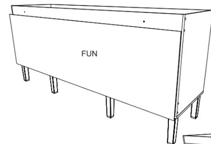
Posicione o fundo e coloque os pregos 8x8 nas laterais direita (LAD) e esquerda (LAE), na barra de fundo (BF) e na base (BA).
