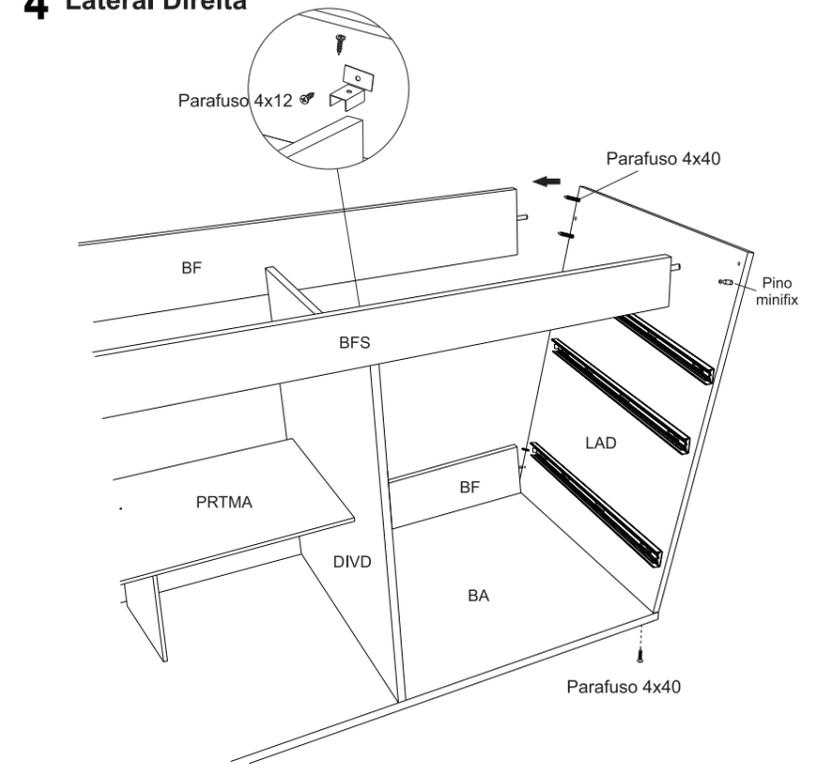
Encaixe a parte de baixo da lateral direita (LAD) na base (BA) por meio das cavilhas. Em seguida, encaixe a parte superior da lateral nas barras de fundo (BF) e frontal superior (BFS), também pelas cavilhas. Utilize parafusos 4x40 para fixar a lateral nas barras. Parafuse a cantoneira na parte superior da divisória direita (DIVD) e esquerda (DIVE) na barra frontal superior (BFS) com parafusos 4x12. Repita o processo para a barra de fundo (BF).
