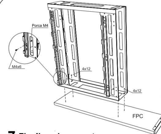
Desmonte o trilho telescópico através das travas plásticas que eles possuem. Posicione o trilho menor na parte lateral externa do porta condimentos (conforme detalhe). Utilize parafuso M4x6 e porca M4 para fixar o trilho. Em seguida, posicione o porta condimentos na frente do porta condimentos (FPC) e finalize fixando com parafusos 4x12.
