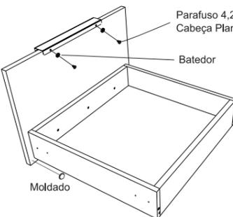
5. Fixe os puxadores com os Parafusos 4,2x9,5mm Cabeça Plana lembrando de colocar os batedores entre o parafuso e puxador, após a fixação **coloque os moldados de silicone nas gavetas de colocar o Moldado somente nas laterais inferiores.**
