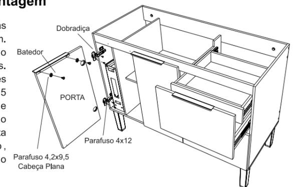
Encaixe as gavetas e o porta condimentos no gabinete, certifique-se de que a parte menor do trilho esteja encaixada dos dois lados nos trilhos telescópicos e empurre. Certifique-se que as gavetas e o porta condimentos estejam funcionando corretamente. Cole os tapa-furos nas furações de parafusos das laterais.
