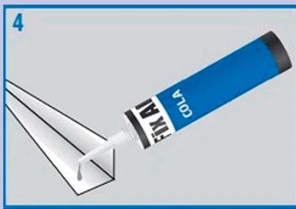
Com a peça no tamanho correto, escolha a forma de fixação do acabamento na parede, a mesma pode ser fixada com cola ou fita dupla face.
