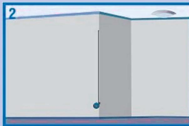
Utilizando a trena, meça o local onde o acabamento L PVC será instalado.
