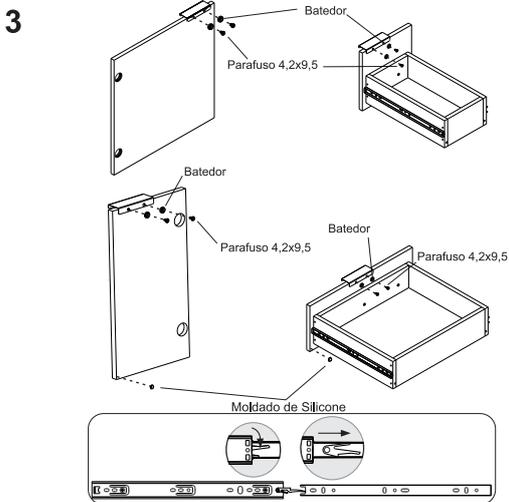
Utilize os parafusos 4,2x9,5 para fixar os batedores nas portas. Os adesivos de silicone protetores do lado internos das portas conforme figura.
