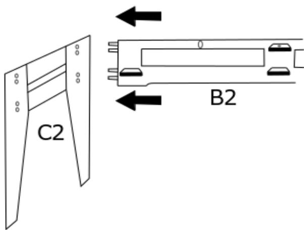
Una os pés do aparador (peça C) com as laterais (peça A e B), de acordo com os encaixes, unindo as quatro peças formara o quadro do aparador
