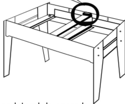
Posicione a peça(F) abaixo do batente existente na lateral do aparador conforme imagem e fixe com parafuso(I) pequeno que acompanha este produto
