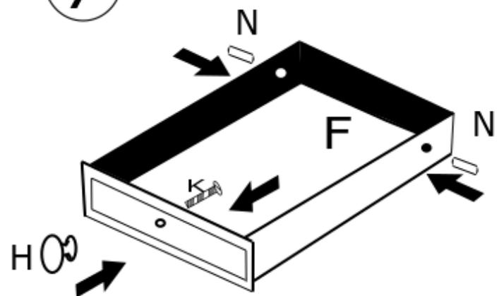
Corte os parafusos intervalados(K) de acordo com a necessidade e fixe os puxadores nas gavetas conforme indica a imagem. Encaixe a gaveta na mesa e fixe a cavilha.
