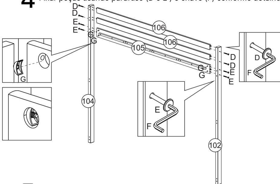
**5** Fixar conjunto montado usando parafuso (C) e chave (F) conforme detalhe.
