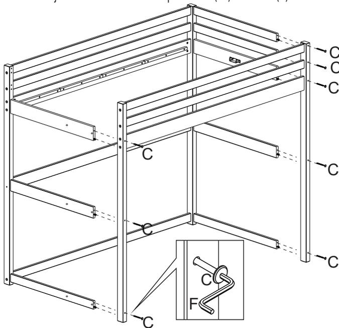
**6** Fixe a travessa (117) usando parafuso (B) conforme detalhe.
