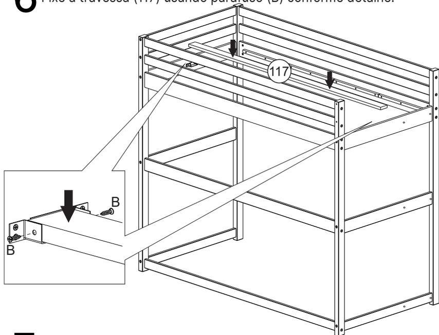
**7** Fixe a travessa (117) usando parafuso (B) conforme detalhe.
