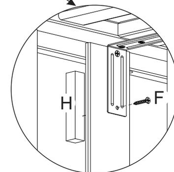
Faça a fixação do espaçador (H) junto ao estrado conforme mostra desenho, pois o mesmo deverá ser utilizado posteriormente, caso a cama precise ser remontada.
