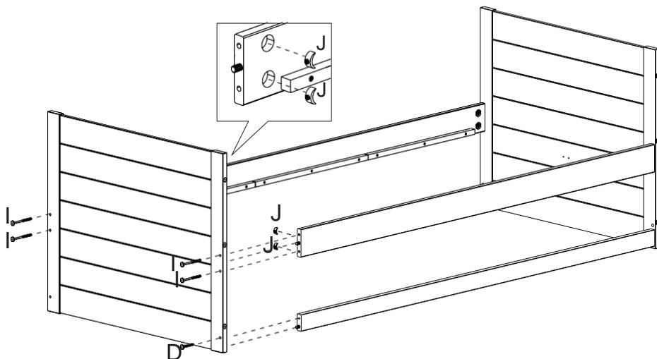
**8** Fixar travessas estrado (206) usando o espaçador (G) e parafuso (K) conforme detalhe.
