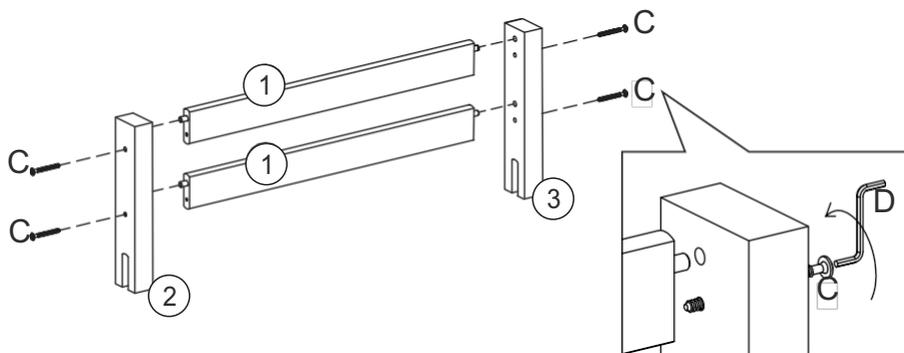
**3** Encaixe a grade montada na cama e fixe usando parafuso [B].
