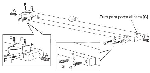
Para formar a lateral esquerda [1E], aplique as cavilhas [A] nos topos da peça [1]. Com os furos para a porca elíptica [C] voltadas para cima, fixe o rodízio [E] na ponta DIREITA da peça [1], usando parafuso [F] e o pé [5] na ponta ESQUERDA, usando parafuso [G].
